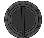
Tokom brušenja dugme 5 podešiti na poziciju BRUŠENJE/GRIND, čime se isključuje zatamnjivanje.
