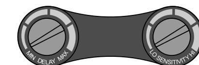
Operátor má možnosť nastaviť dobu oneskorenia preponenia filtra z tmavého na svetlý s použitím kolieska ONE SKORENIE/DELAY umiestneného na kazete filtra vedľa kolieska nastavenia citlivosti – CITLIVOSŤ/SENSITIVITY. Toto koliesko umožňuje plynulé nastavovanie času reakcie filtra od 0,1s do 1,0s.
