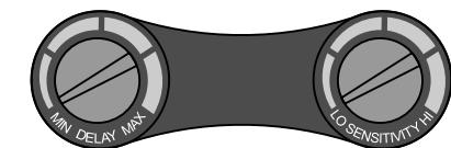
Uporabnik lahko nastavi čas zakasnitve preklopa filtra s temnega na svetlega ob uporabi vrtljivega gumba ZAKASNITEV/DELAY, namečenega na kaseti filtra zraven vrtljivega gumba za prilagoditev občutljivosti – OBČUTLJIVOST/SENSITIVITY. Vrtljiv gumb omogoča brezstopenjsko nastavitev odzivnega časa filtra od 0,1s do 1,0s.
