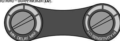
Оператор может регулировать время задержки переключения светофильтра из тёмного в светлое состояние при помощи ручки **ЗАДЕРЖКА/DELAY**, находящейся на кассете светофильтра возле ручки регулировки чувствительности – **ЧУВСТВИТЕЛЬНОСТЬ/SENSITIVITY**. Эта ручка позволяет плавно регулировать время задержки в пределах от 0,1 с до 1,0 с.
