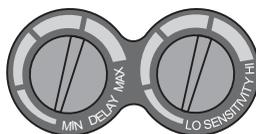
Operatorul are posibilitatea de a ajusta durata de întârziere a schimbării filtrului de la închis la deschis folosind butonul **ÎNȚĂRZIERE/DELAY** amplasat pe caseta filtrului lângă butonul de ajustare a sensibilității – **SENSIBILITATE/SENSITIVITY**. Acesta permite ajustarea ușoară a timpului de reacție a filtrului între 0,1 și 1,0 s.
