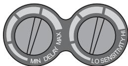
Оператор может регулировать время задержки переключения светофильтра из тёмного в светлое состояние при помощи ручки **ЗАДЕРЖКА/DELAY**, находящейся на касете светофильтра возле ручки регулировки чувствительности – **ЧУВСТВИТЕЛЬНОСТЬ/SENSITIVITY**. Эта ручка позволяет плавно регулировать время задержки в пределах от 0,1 с до 1,0 с.
