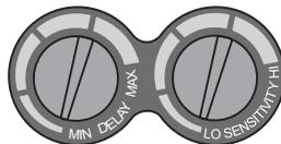
Operátor má možnost nastavit dobu opoždění přepojení filtru z tmavého na světlý s použitím kolečka **OPOŽDĚNÍ/DELAY** umístěného na kazetě filtru vedle kolečka nastavení citlivosti – **CITLIVOST/SENSITIVITY**. Toto kolečko umožňuje plynulé nastavování času reakce filtru od 0,1 s do 1,0 s. Doba opoždění kompenzuje efekt dosvitu vzniklého na svářeném prvku. Nastavení **MIN** (minimální hodnota doby opoždění), **MAX** (maximální hodnota doby opoždění).
