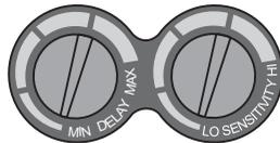
Operatoram ir iespēja regulēt filtra kavējuma pārslēgšanas laiku no tumšāka uz gaišāku ar regulatoru **KAVĒJUMS/DELAY**, kurš atrodas uz filtra kasetes blakus jūtības regulatoram – **JŪTĪBA/SENSITIVITY**. Šis regulators dod filtra reakcijas bezpakāpju regulācijas iespēju no 0,1 s līdz 1,0 s.
