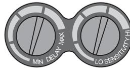
Operater ima mogućnost podešavanja vremena odgode prelaska filtera iz tamnoga u svijetli način rada pomoću dugmeta **ODGODA/DELAY** smještenog na kaseti filtera pored dugmeta osjetljivosti – **OSJETLJIVOST/SENSITIVITY**. To dugme omogućava jednostavno podešavanje vremena reakcije filtera od 0,1 s do 1,0 s.
