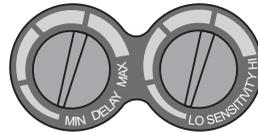
Operator má možnosť nastaviť dobu oneskorenia prepínanie filtra z tmavého na svetlý s použitím kolieska **ONESKORENIE/DELAY** umiestneného na kazete filtra vedľa kolieska nastavenia citlivosti – **CITLIVOSŤ/SENSITIVITY**. Toto koliesko umožňuje plynulé nastavovanie času reakcie filtra od 0,1 s do 1,0 s.
