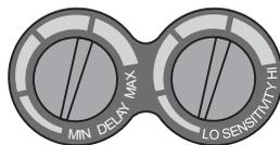
Operator ma możliwość regulacji czasu zwłoki przełączania filtra z ciemnego na jasny przy pomocy pokrętki **OPÓZNIENIE/DELAY** umieszczonej na kasecie filtra obok pokrętki regulacji czułości – **CZUŁOŚĆ/SENSITIVITY**. Pokrętło to umożliwia płynną regulację czasu reakcji filtra od 0,1 s do 1,0 s.
