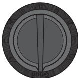
Plynulé nastavení citlivosti filtru na elektrický oblouk se provádí kolečkem CITLIVOST/SENSITIVITY umístěným na kazetě filtru. Pro nízké proudy nebo pro metodu TIG se doporučuje vyšší nastavení (**HI**), pro vysoké proudy nebo metodu MIG/MAG nižší hodnoty (**LO**).
