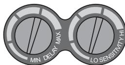
Uporabnik lahko nastavi čas zakasnitve preklopa filtra s temnega na svetlega ob uporabi vrtljivega gumba **ZAKASNITEV/DELAY**, nameščenega na kaseti filtra zraven vrtljivega gumba za prilagoditev občutljivosti – **OBČUTLJIVOST/SENSITIVITY**. Vrtljiv gumb omogoča brezstopenjsko nastavitve odzivnega časa filtra od 0,1 s do 1,0 s.
